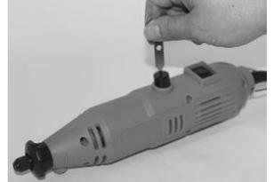
1. 换碳刷的时候，需准备小扳手 2. 把小扳手的小头那端，插入雕刻钻一端的碳刷盒盖的一字型槽内，拧出碳刷盒盖
