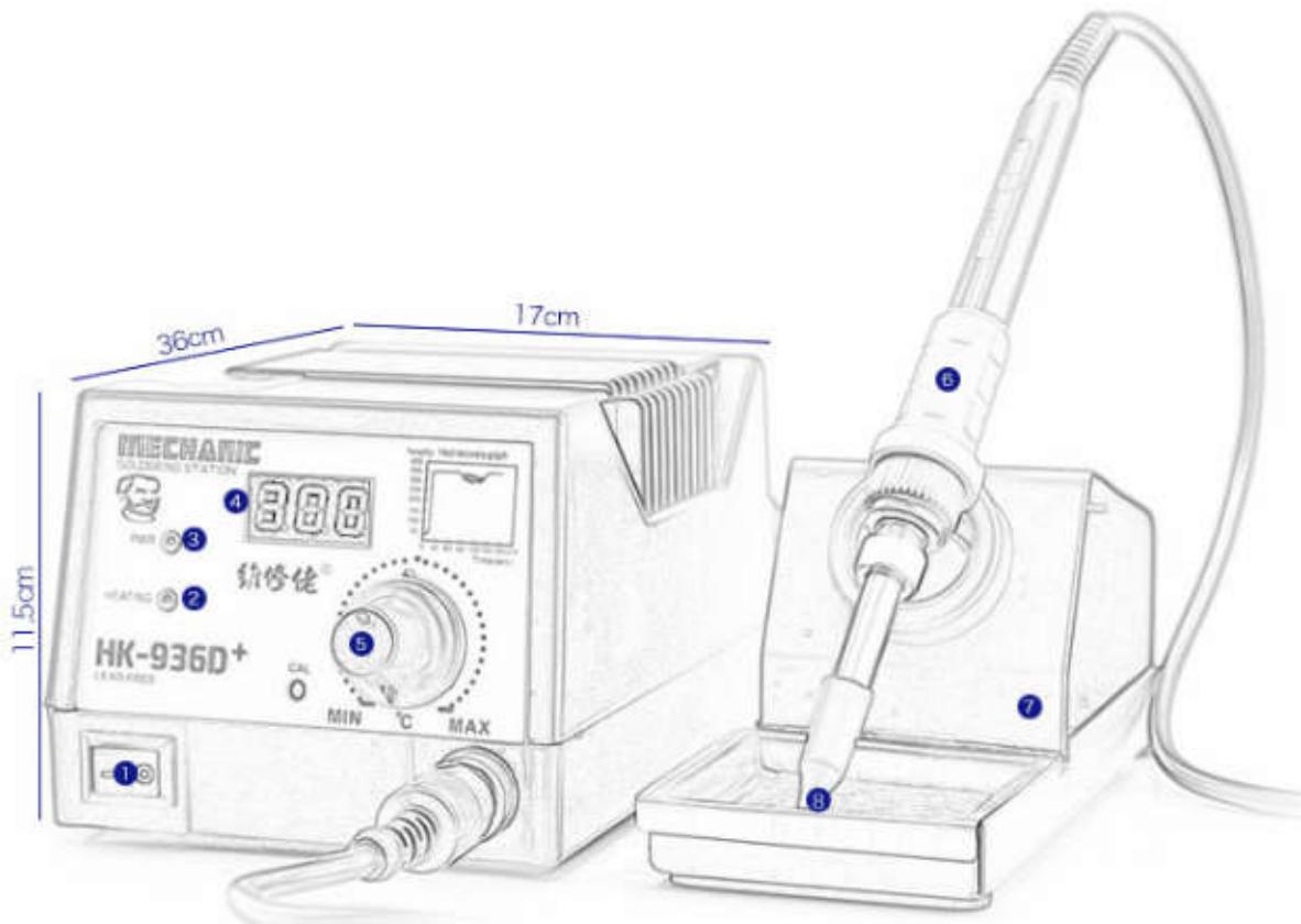
① 电源开关 ② 发热指示灯 ③ 电源指示灯 ④ 温度显示屏 ⑤ 温度调节钮 ⑥ 908A烙铁 ⑦ 精修烙铁座 ⑧ 耐高温海绵
